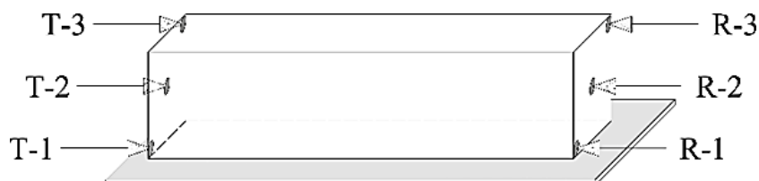
Obrázek 11.3: Schématické zobrazení měření doby průchodu ultrazvukového vlnění s vyznačenými měřicími liniemi; T je budič (transmitter) a R je přijímač (receiver).
