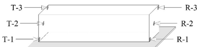
Obr. 2.10.: Schématické zobrazení měření doby průchodu UZ vlnění s vyznačenými měřicími liniemi; T je budič (transmitter) a R je přijímač (receiver) [2.13].
