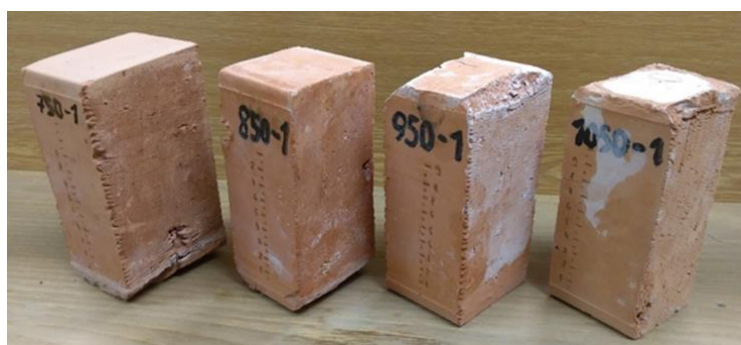
Obr. 9.10.: Vzorky cihel po zkoušce na výkvětovost podle ČSN 72 2608, metoda B.
