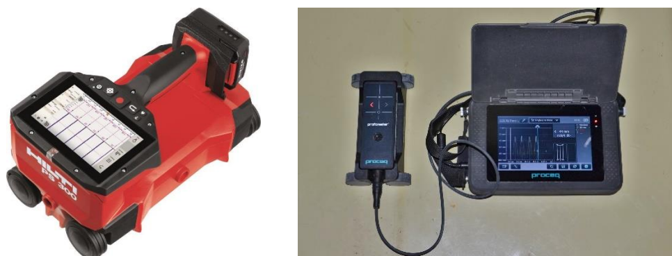
Obr. 7.2.: Profesionální přístroje pro vyhledávání výztuže – vlevo PS 300 Ferrosan od firmy Hilti [7.5], vpravo Profometer PM-630 od firmy Proceq.
