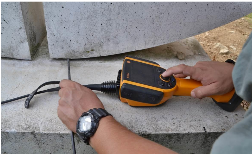
Obr. 13.13.: Prohlídka spáry mezi soklem a diskem plastiky pomocí videoskopu GE XL Go+ VideoProbe.
