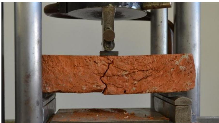
Obr. 9.7.: Zkouška pevnosti v tahu za ohybu cihel o rozměrech přibližně 290×140×65 mm, vzdálenost podpěr 240 mm.
