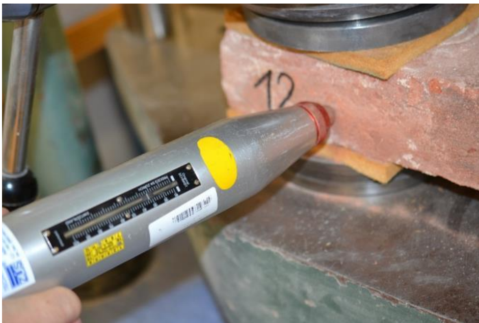
Obr. 10.4.: Tvrdoměr Schmidt LB pro zkoušení cihelného zdiva. Upřesnění regresního vztahu se následně provádí na celých cihlách zatížených v lisu.
