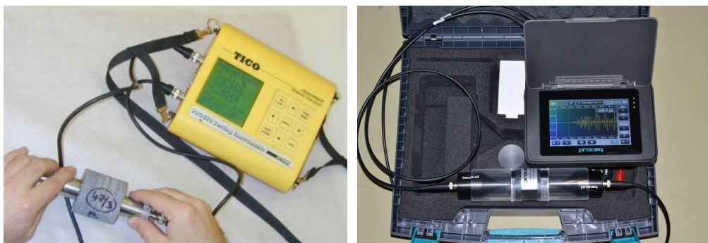
Obr. 4.5.: Ultrazvukový přístroj TICO (vlevo) s digitálním výstupem měřené doby průchodu UZ vlnění a nový přístroj PUNDIT PL-200 s paměťovým osciloskopem. [foto P. Cikrle]
