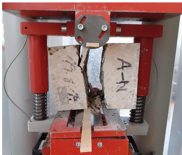
Obr. 2.6.: Typické porušení zkušebního tělesa při stanovení pevnosti betonu v příčném tahu.
