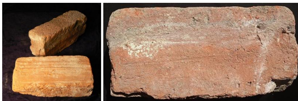
Obr. 9.2.: Vlevo prstované cihly (cca 13. stol.), vpravo lícová strana cihly se stopami seřiznutí nástrojem (Rosa Coeli, Dolní Kounice, 15. stol.).
