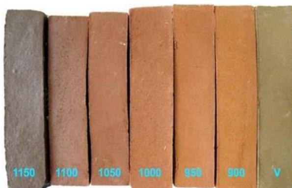
Obr. 9.1.: Barva střepeu dle teploty výpalu (V – výsušek).
