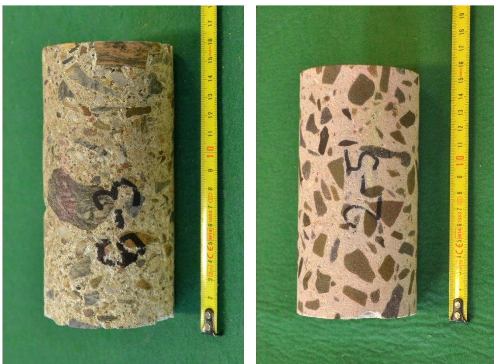
Obr. 5.2.: Vlevo jádrový vývrt, kde velikost zrn kameniva výrazně přesahuje 1/3 průměru vývrtnu, což má značný vliv na výsledky zkoušek. Vpravo vývrt s kamenivem do 1/3 průměru, bez ovlivnění výsledků pevnosti v tlaku.
