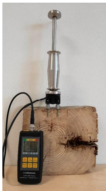
Obr. 11.15.: Odporový přístroj na měření vlhkost dřeva se zářezací sondou.
