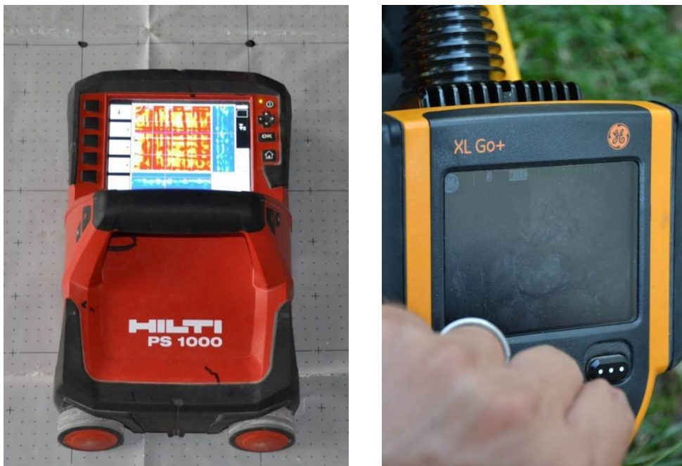
Obr. 13.2.: Použité přístroje – vlevo radar Hilti PS 1000 X-Scan, vpravo videoskop GE Go+.
