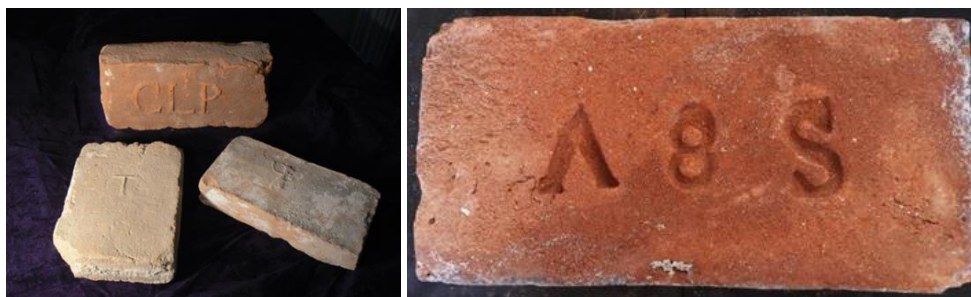
Obr. 9.5.: Vlevo typické pozitivní kolky (cca 18.-19. stol.), vpravo jednoduchý negativní kolek vytvořený značkami připevněnými na dno formy (Brno, patrně Adalbert Satzger mezi lety 1860 a 1870).
