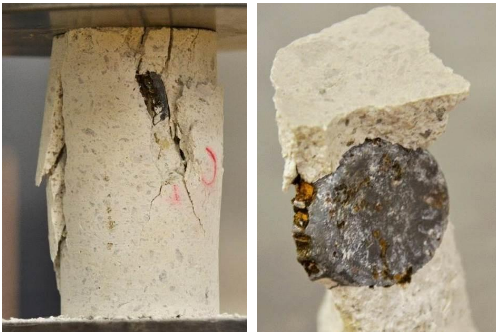
Obr. 13.6.: Při zatěžování a po rozdrčení zkušební tělesa č. 2 se ukázalo, že skrývá starý kovový uzávěr lahve.
