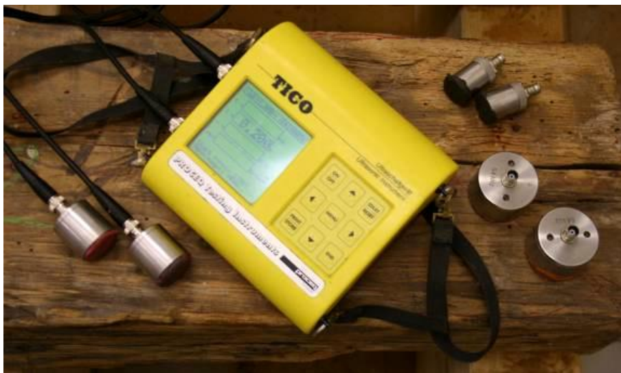
Obr. 11.16.: Ultrazvukový přístroj TICCO umožňuje použití více sond o různých frekvencích [11.5].
