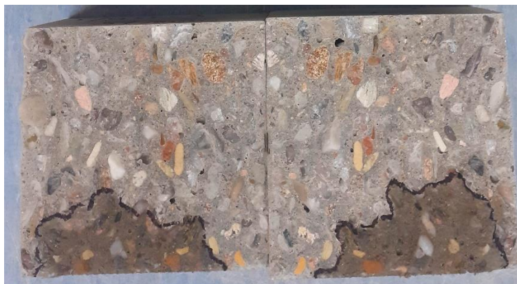
Obr. 2.21.: Rozlomená zkušební krychle po zkoušce průsaku tlakovou vodou s vyznačenou hranicí průsaku tlakové vody.
