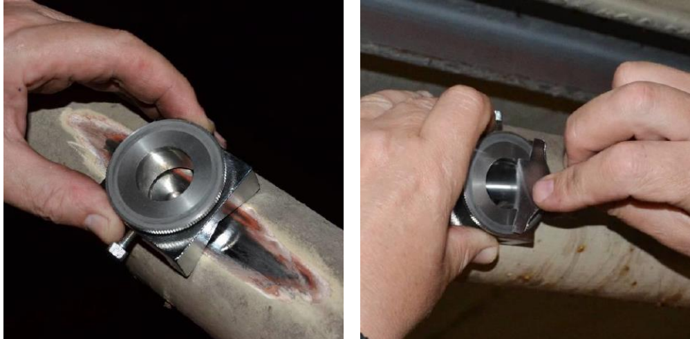
Obr. 6.9.: Příprava měření na zaoblených površích (např. trubkách) použitím podstavce ve tvaru „V“ a nastavením vzdálenosti od povrchu pomocí kalibrační měrky.
