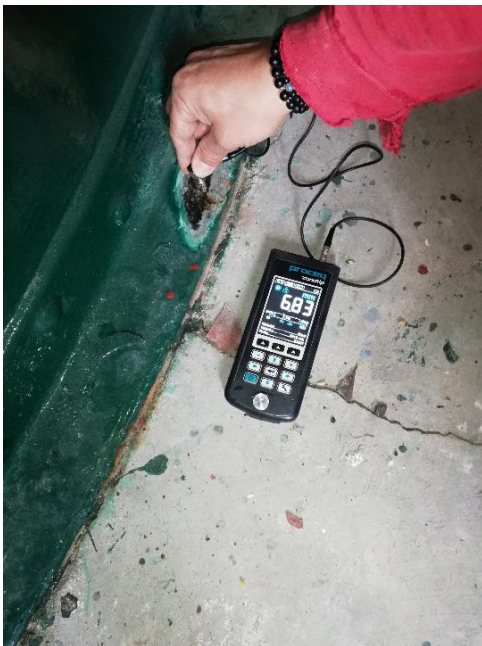
Obr. 6.11.: Ukázka měření tloušťky příruby a stěny přístrojem Zonotip.
