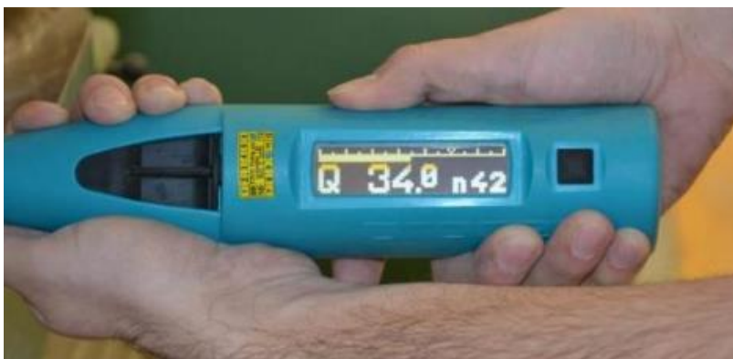
Obr. 4.4.: Digitální integrovaný tvrdoměr Silver Schmidt N se záznamem naměřených dat [foto P. Cikrle].
