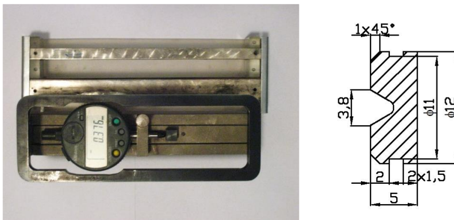
Obr. 10.8.: Hollanův mechanický příložený dilatometr pro měření posunů v trhlinách. Vpravo – schéma mosazného terče se závrtu, který zůstává osazen na konstrukci, měří se změna vzdálenosti dvojice či soustavy těchto terčů.
