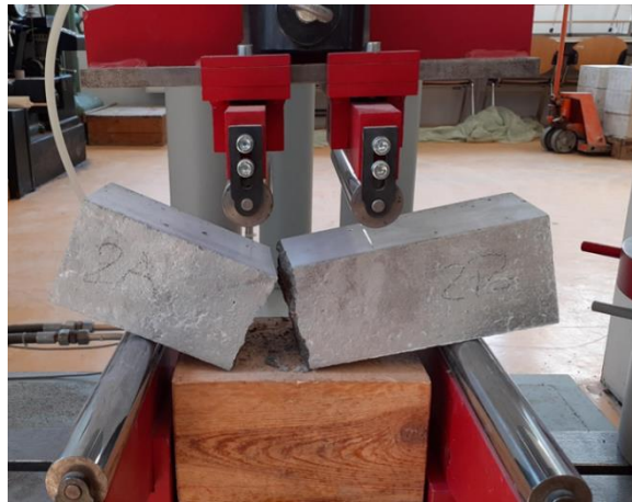
Obr. 2.7.: Korektní porušení zkušebního tělesa (v místě maximálního ohybového momentu, tzn. mezi zatěžovacími válečky) při stanovení pevnosti betonu v tahu ohybem.
