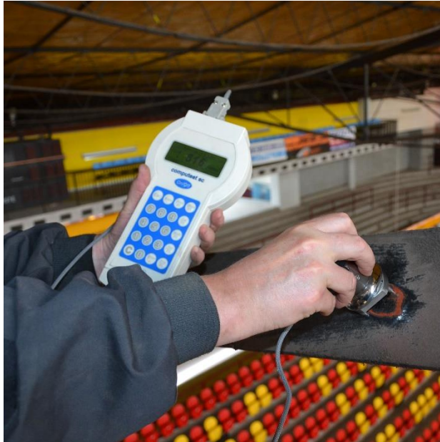
Obr. 6.7.: Přenosný tvrdoměr COMPUTEST SC od švýcarské firmy Ernst Härteprüfer SA, pracující na principu tvrdoměru podle Rockwella.
