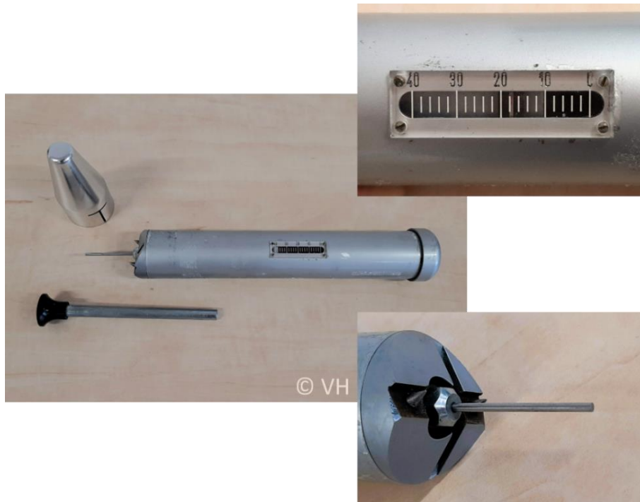
Obr. 11.18.: Pilodyn 6J pro odporové zarážení trnu.
