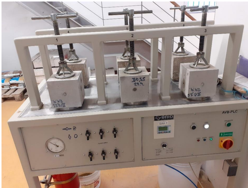
Obr. 2. 19.: Zkušební krychle osazené v zařízení pro stanovení hloubky průsaku tlakovou vodou.
