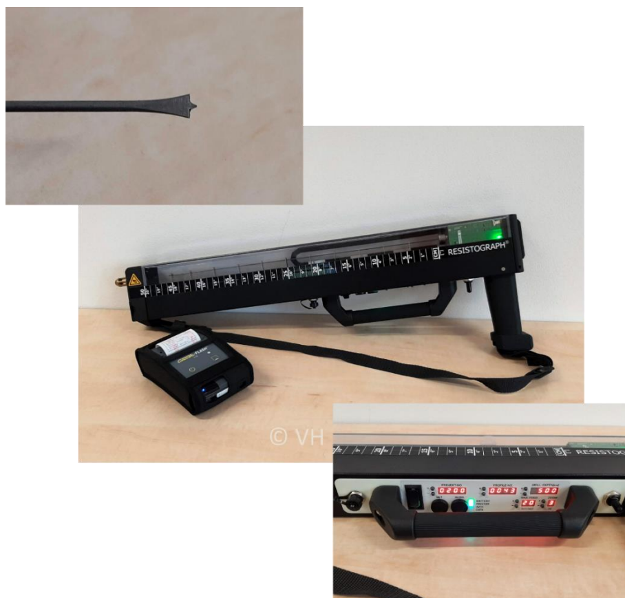
Obr. 11.19.: Příklad přístroje Resistograph firmy Rinntech.
