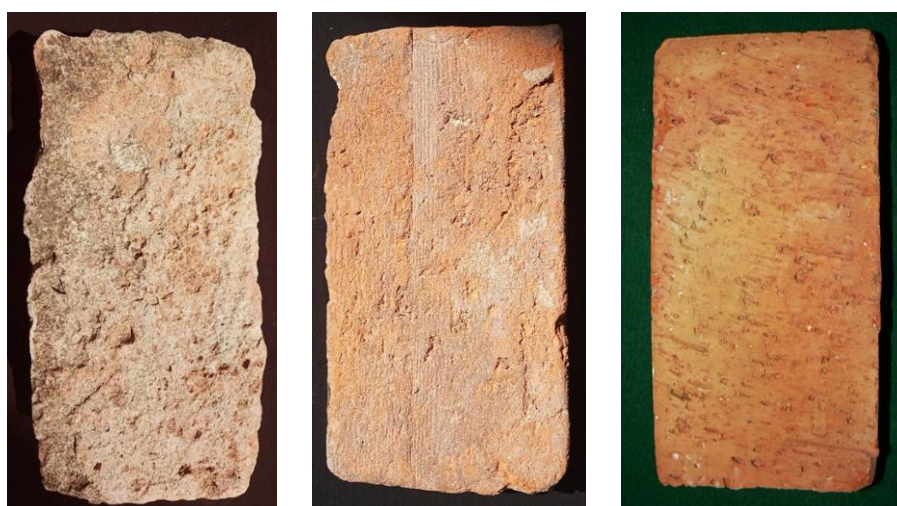
Obr. 9.3.: Vlevo stopy podsypu na spodní straně gotické prstované cihly uprostřed stopy po nehoblovaných prknech na barokní cihle a vpravo známky řezání cihly z nekonečného pásu vytlačného šnekovým lisem – moderní výroba.
