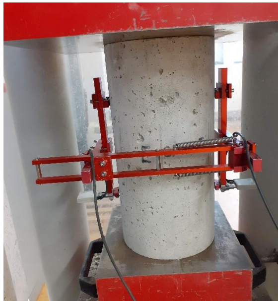
Obr. 2.14.: Osazení dvou snímačů deformací na protilehlé strany zkušební tělesa.
