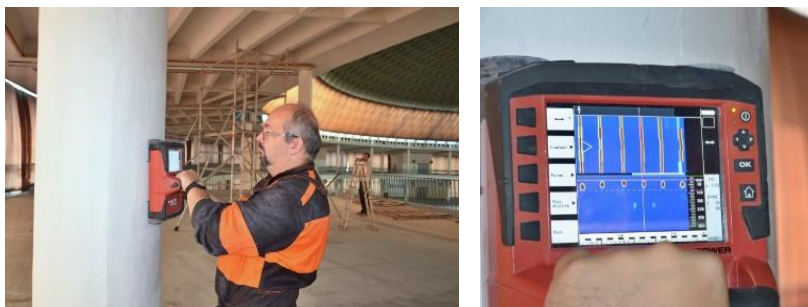
Obr. 8.8.: Měření hlavní výztuže na sloupech nesoucích galerii ve 2. NP Pavilonu Z na Brněnském výstavišti bylo prováděno s mírným pozvednutím čelní části sondy, sonda i v tomto režimu poskytuje relevantní zobrazení polohy hlavních výztuží.
