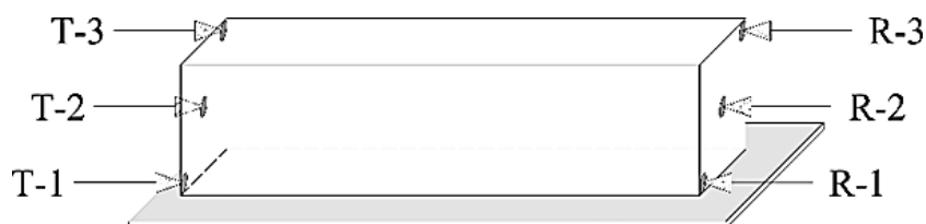
Obrázek 11.3: Schématické zobrazení měření doby průchodu ultrazvukového vlnění s vyznačenými měřicími liniemi; T je budič (transmitter) a R je přijímač (receiver).
