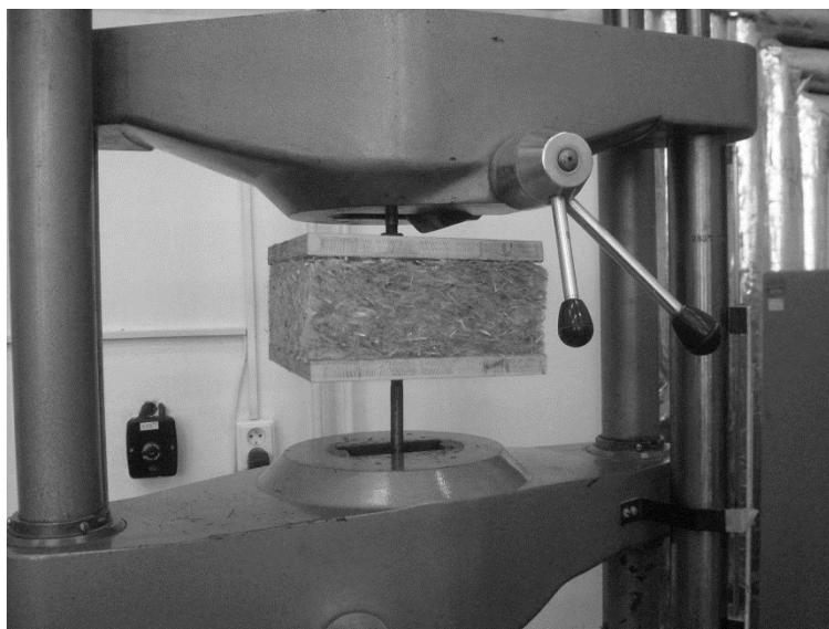
Obrázek 5.1: Vzorek upevněný v lisu před zkouškou pevnosti v tahu kolmo k rovině desky.
