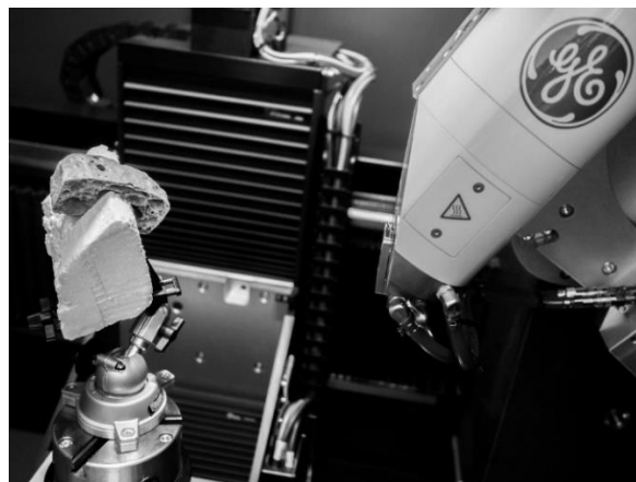
Obrázek 4.7: Rentgenová trubice a umístění vzorku v zařízení V TOMEX 300.
