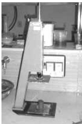
Obrázek 2.1.: Pfefferkornův deformační přístroj, vzorek před deformací.
