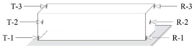
Obr. 11.1: Schématické zobrazení měření doby průchodu UZ vlnění s vyznačenými měřícími liniemi; T je budič (transmitter) a R je přijímač (receiver).
