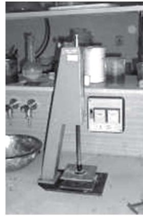
Obrázek 2.2.: Pfefferkornův deformační přístroj, vzorek po deformaci.
