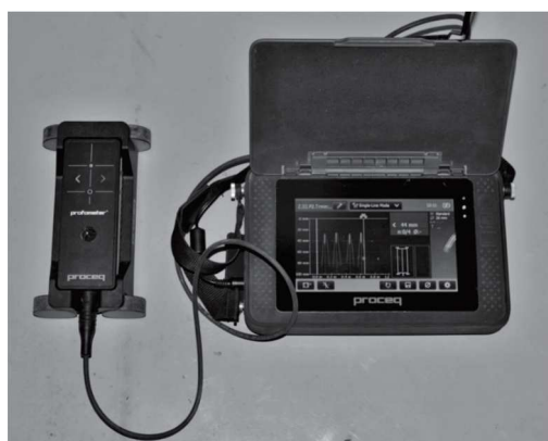
Obrázek 8.7: Profometer PM-630 s dotykovým displejem a integrovanou sondou; svítící šipky pomáhají lokalizovat výztuž, na displeji lze ihned kontrolovat správnost měření pomocí křivek intenzity signálu. Vpravo záznam měření krytí výztuže.
