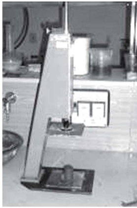
Obrázek 2.1.: Pfefferkornův deformační přístroj, vzorek před deformací.
